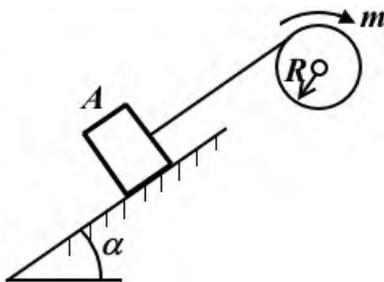
положив:  $P = 1 \text{ кН}$ ,  $Q = 0,5 \text{ кН}$ ,  $m = 0,5 \text{ кНм}$ ,  $f = 0,2$ ,  $R = 20 \text{ см}$ ,  $s = 10 \text{ м}$ ,  $\alpha = 45^\circ$ .
